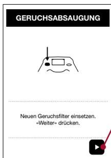
Setzen Sie einen neuen Geruchsfilter ein. Beachten Sie dabei die Führungsrippen am Geruchsfilter.
